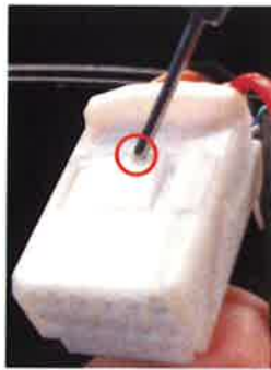
② コネクタの②クリップ嵌合を [A] 等で持ち上げ外します。
