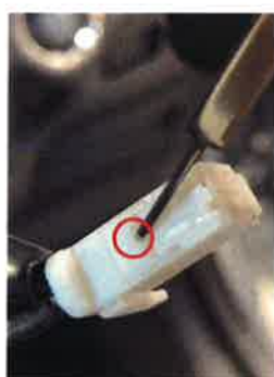
② コネクタの○クリップ嵌合を [A]等で持ち上げ外します。
