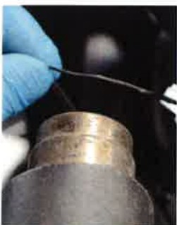
⑤ 伸縮チューブにヒートガン等で 熱を加え密着させ保護します。
