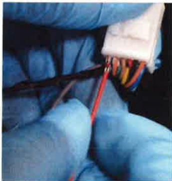
① 水色の端子を抜いた 7 番に付属の電源部 4P ハーネスコネクタをしっかりと挿入しクリップ嵌合を元に戻します。
