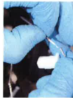
④ 押し外した水色メス端子と付属配線アース部ハーネスのオス端子を接続し、付属の伸縮チューブにて保護します。
