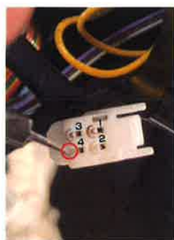
③ ○4番の灰色メス端子を [A]等で画像のように 押し外し、持ち上げてある クリップ嵌合を元に戻します。
