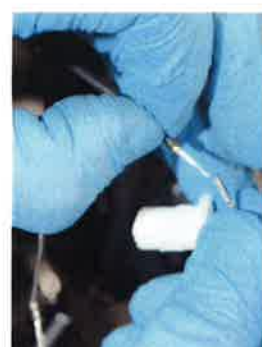
④ 押し外した灰色メス端子と 付属配線のアース部ハーネスのオス端子を接続し、 付属の伸縮チューブにて保護します。
