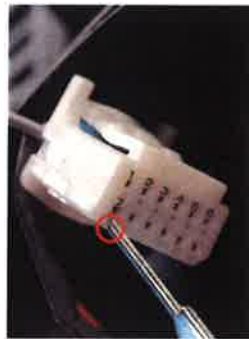
③ ③の7番の水色メス端子を [A] 等で画像のように押し外します。
