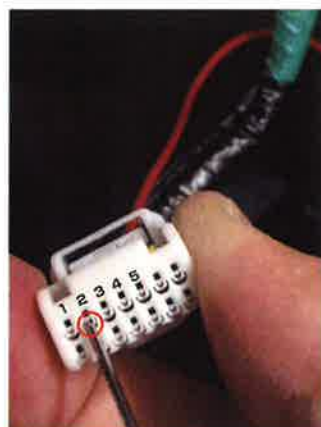
③ ○2番の黒色アース線端子を [A]等で画像のように押し外し、 送信部から引っ張ってきた 付属の電源供給線端子 A を挿入します。
