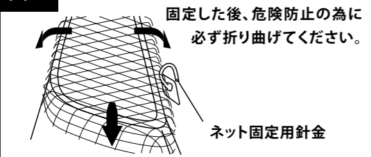
図2 ※付属のネットは固定用針金で固定した後、危険防止の為に必ず折り曲げて下さい。
