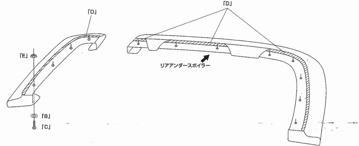
1. 純正リアバンパーの底面に「リアアンダースポイラー」を仮合わせし、位置決めをします。
