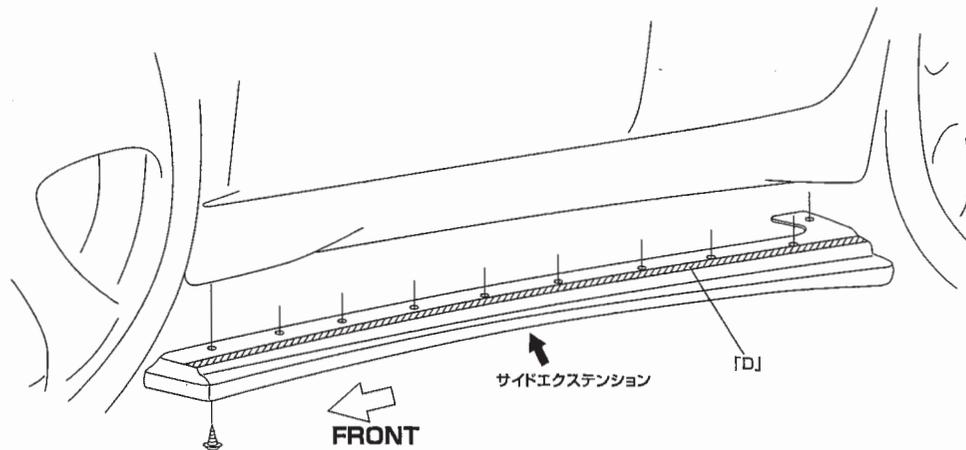
1. 純正サイドスカートの底面を止めている純正ねじを外します。
